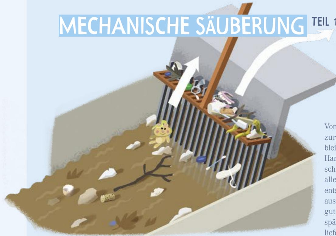
Vom **Hebewerk** fließt das Abwasser zur **Rechenanlage**. An seinen Stäben bleibt der feste Abfall hängen. Eine Harke entfernt alles vom Gitter und schüttet es in eine Presse. Die drückt alles Wasser aus ihnen heraus. So entsteht jeden Tag etwa 3 bis 4 Tonnen ausgepresstes Material. Das Rechengut kommt in einen Container. Es wird später als **Brennstoff** verwendet und liefert so Energie.
