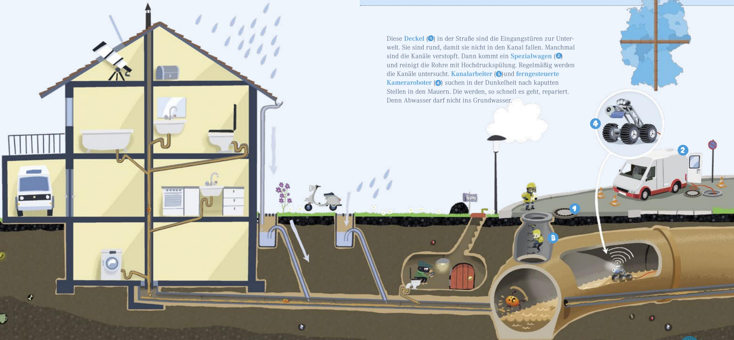
Diese **Deckel** (1) in der Straße sind die Eingangstüren zur Unterwelt. Sie sind rund, damit sie nicht in den Kanal fallen. Manchmal sind die Kanäle verstopft. Dann kommt ein **Spezialwagen** (2) und reinigt die Rohre mit Hochdruckspülung. Regelmäßig werden die Kanäle untersucht. **Kanalarbeiter** (3) und **ferngesteuerte Kameraroboter** (4) suchen in der Dunkelheit nach kaputten Stellen in den Mauern. Die werden, so schnell es geht, repariert. Denn Abwasser darf nicht ins Grundwasser.
